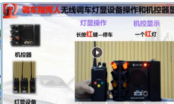
图8 微课---无线调车灯显设备操作
